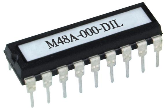
Figure 1: M48A-000-DIL modem IC
